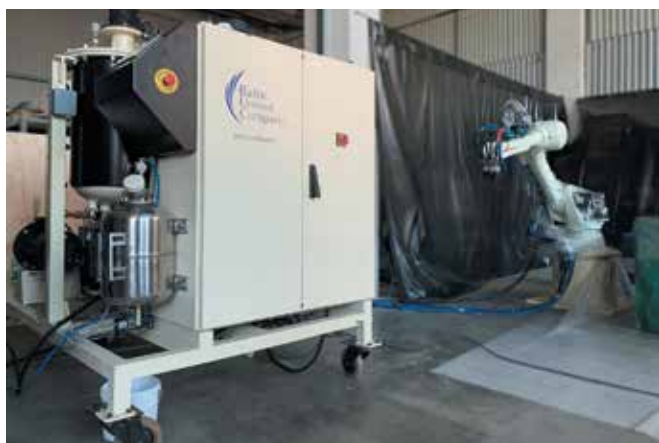
Рис. 18. Установка высокого давления серии HiStream Spray для напыления ППУ, оснащенная многоосевым роботом с распылительной головкой (источник рис. 18–19: ООО «Регент Балтика»)
