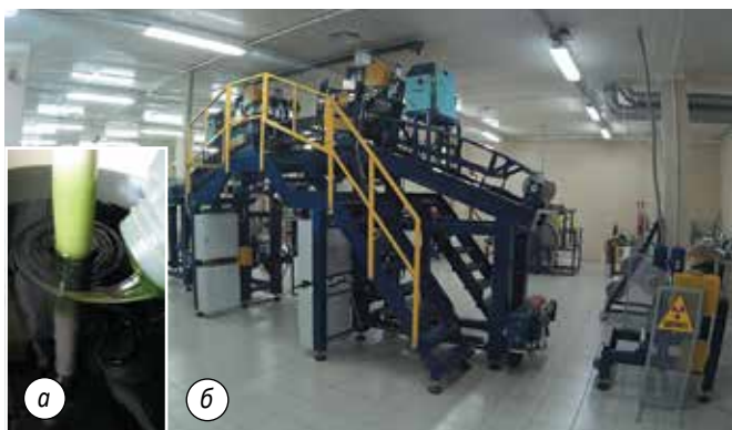
Рис. 5. Внешний вид специального связующего (а) и автоматизированная машина, разработанная и изготовленная для пропитки им углеродного волокнистого наполнителя, в том числе высокомолекулярного (б)
