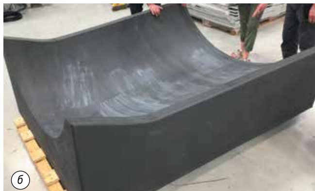
Рис. 8. Гибридная система CMS-KREATOR на базе ОЦ ARES 4826 (а) и изготовленная на ней крупногабаритная полимерная оснастка (б)
